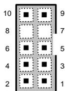
Разъём X 2. Подключение питания и линий связи.
