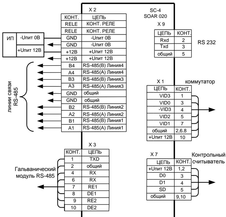
Разъём X 1. Подключение видеокоммутатора.
