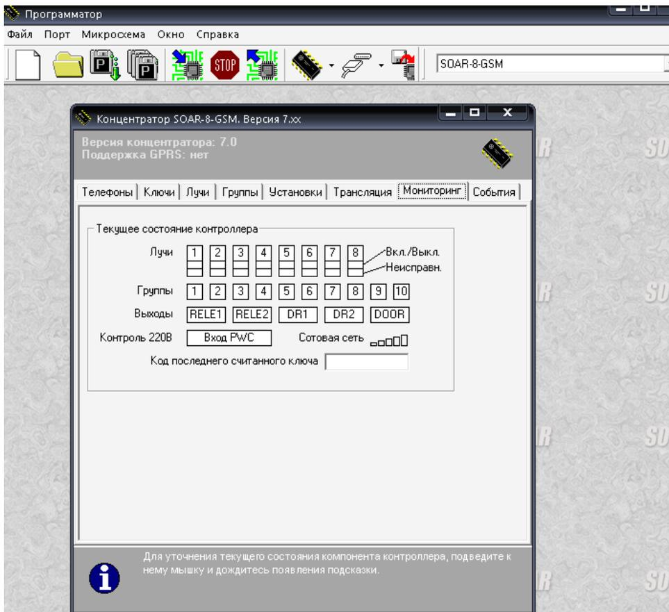
Подключите контроллер к компьютеру посредством кабеля. Запустите программу “Программатор”. Выберите в меню “Порт” порт “USB”. В меню “Окно” выберите “Контроллер SOAR-8-GSM”. Дождитесь, пока из контроллера будут прочитаны его текущие установки. После этого можно проводить мониторинг состояния контроллера, выбрав закладку “Мониторинг” или просмотреть список событий, выбрав закладку “События”
