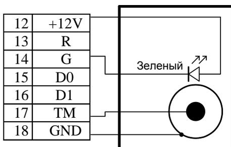
Схема подключения считывателя с интерфейсом Wiegand
