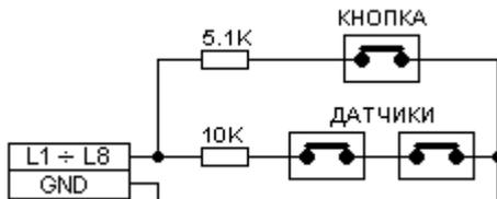
Для обеспечения надёжной работы после монтажа необходимо убедиться, что напряжения на входах контроллера с L1 по L8 относительно клеммы GND соответствуют следующей таблице:
