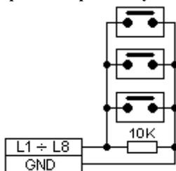
Для режима 5 могут использоваться датчики и кнопки только с нормально замкнутыми контактами. Схема включения следующая:
