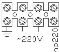
Если не используется вход контроля напряжения питания “PWC”, подключите его к клемме “+12V”. При использовании доработанного блока питания ВР-12-1, вход “PWC” подключается к контакту “no220” на колодке блока питания, как показано на рис.
