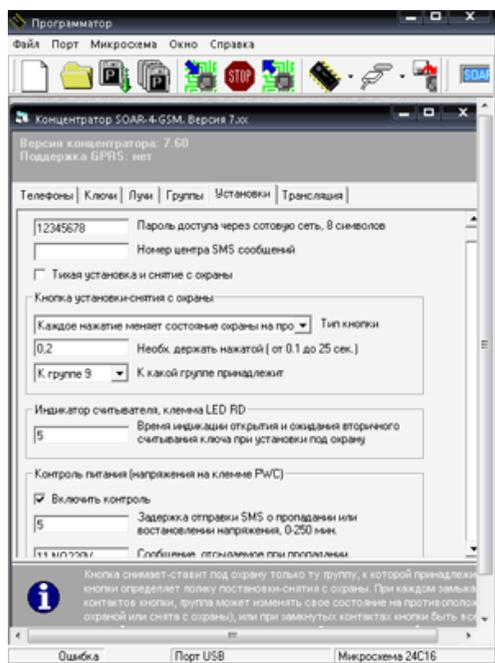
Конфигурация контроллера, номера телефонов, мастер ключи и ключи пользователей хранятся в микросхеме энергонезависимой памяти ATMEL 24C16. Эту микросхему можно вынуть из панели на печатной плате контроллера и изменить её содержимое с помощью программатора SOAR, подключаемого к компьютеру. Программатор в комплект контроллера не входит и приобретается отдельно.
